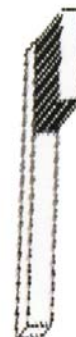
BRUSH 용접작업 후에 몰드 내에 남아 있는 SLAG와 다른 이물질을 제거하는데 사용.
