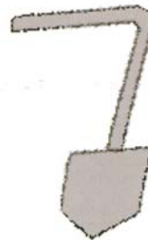
SCRAPER 용접작업 후에 몰드내에 남아 있는 SLAG와 이물질 제거 및 케이블 이물질 제거에 사용.
