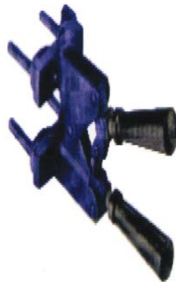
HANDLE CLAMPS 분리된 몰드를 고정하기 위하여 사용되며 몰드의 크기와 형태에 따라 大, 中, 小 특수 타입으로 구분됨.
